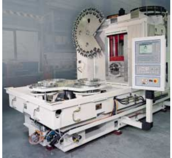
Maschinenbett für 4-fach Palettenwechsler und aufgesetzter Maschinen-Oberständer mit Kreuzschlitten (X- und Y-Achse) in Kulissenbauform.
