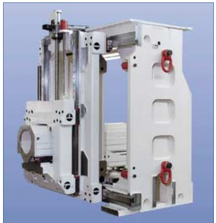
Bild oben: Maschinen-Oberständer mit Kreuzschlitten im Montagestadium.
